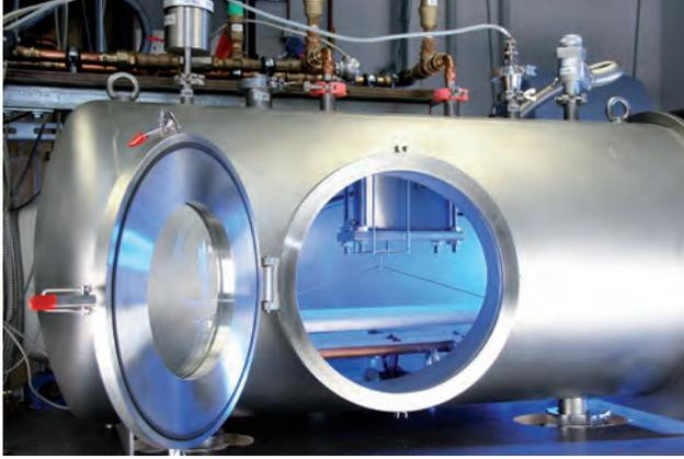
*Gravimetrische Messung der Wasseraufnahme an Wärmeübertragern als Adsorber oder Verdampfer / Kondensator für Wasser im Niederdruckbereich.*
